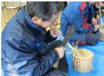
写真12 鉋でクルミの枝を削る
